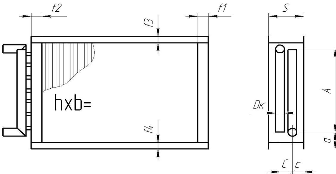
**Внимание:** размеры  $a$ ;  $A$ ;  $c$  и  $C$  можно указывать, но при изготовлении возможна погрешность 5-10% !
